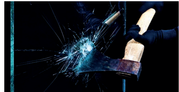
Abb. 7.4: Durchbruchversuch mit Axt
