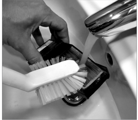
Reinigen des Wärmetauschers
