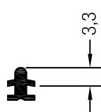
Reduzierprofil Nr. 2 für Rollladenführung
