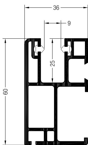
Rollladenführung mit Dämpfungsfahnen
