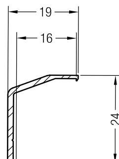
Sattelschiene mit Dichtungsnut
