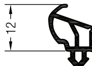
Universaldichtung Nr. 3 (für Spaltmaße 5 bis 8 mm)
