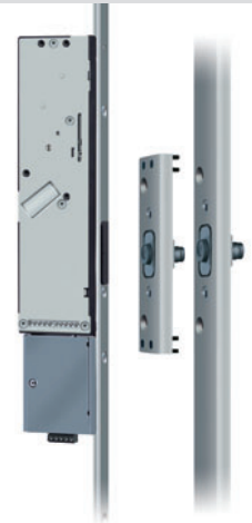
Die Antriebseinheit Der starke Elektromotor von Roto DoorMatic ent- und verriegelt das Schloss: schnell, leise und sicher. Er wird von außen unsichtbar im Türblatt montiert.
